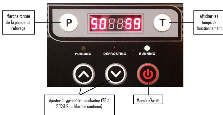
Trois voyants indiquent sur le fonctionnement de la pompe de relevage, l'activation automatique du dégivrage et la mise sous tension de l'appareil.
